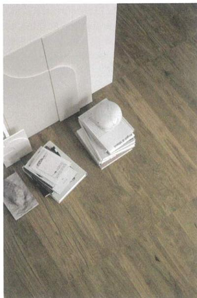
derne Verlegemuster realisieren. Insgesamt sind 14 Artikel in sechs Farben, drei verschiedenen Oberflächenbehandlungen und zwei Sortierungen verfügbar. Dabei kombiniert die moderne HDF-Technologie des 2-Schicht-Parketts eine hohe Leistungsfähigkeit der Trägerschicht mit einem minimalen Verbrauch an natürlichen Holzressourcen für die 2,5 mm dicke Nuttschicht. Vollflächig verklebt, garantiert die Diele ein leises Begehen und überzeugt mit einer optimalen Energieausnutzung auf Fußbodenheizungen.
